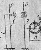
$$\text{Гибкость стержня } \lambda = \frac{\mu c}{i} = \frac{0.7 \cdot 4.3}{309 \cdot 10^2} = 0.7.$$
